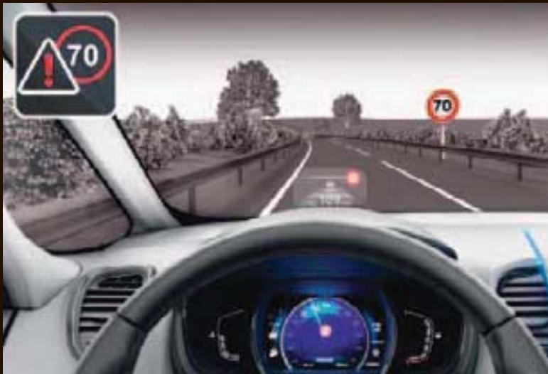
**Alerte de survitesse avec reconnaissance des panneaux de signalisation.** Le système permet d'adapter votre conduite en fonction des données de signalisation recueillies par la caméra. L'alerte visuelle est immanquable grâce au Head-Up Display.
