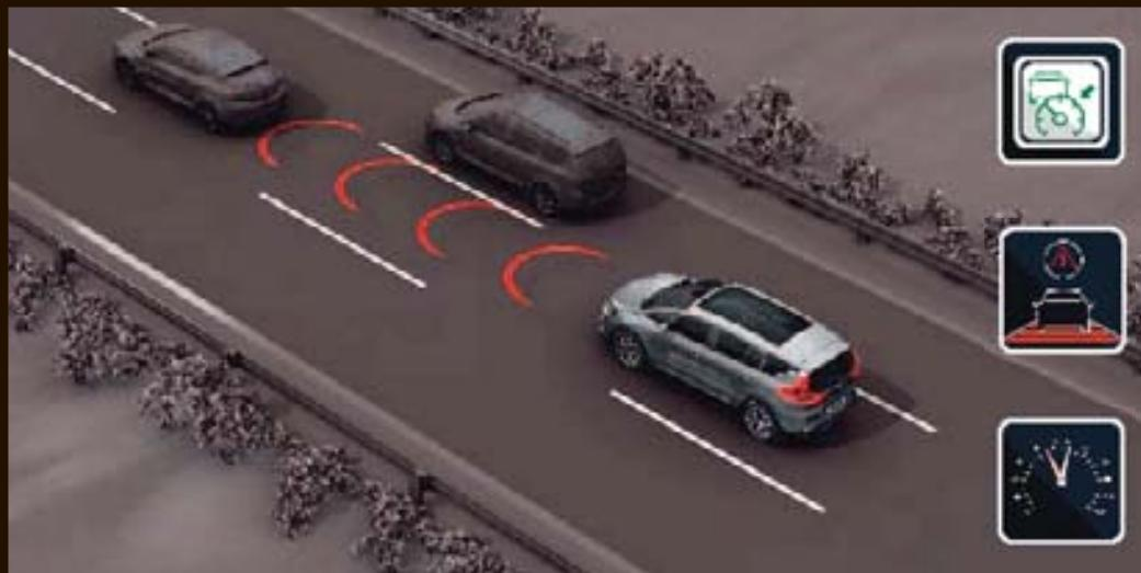
**Freinage actif d'urgence.** En cas de freinage d'urgence, le système agit en complément de l'ABS / ESC pour réduire les distances d'arrêt.
